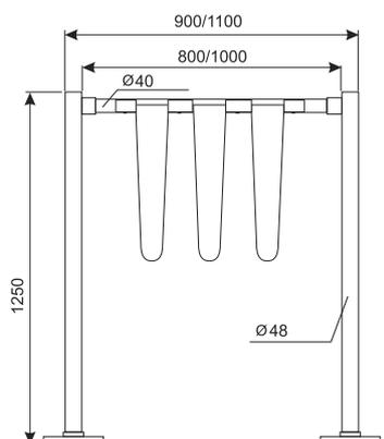
Il passaggio carrelli è costituito da un tubo orizzontale diam. 40 L 800-2000 mm e tre flap in plastica.
